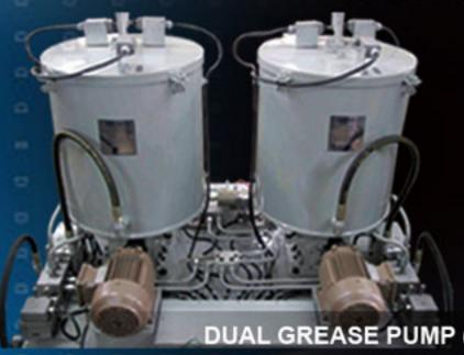
**DUAL GREASE PUMP (WITH DOUBLE CONTAINERS)**
